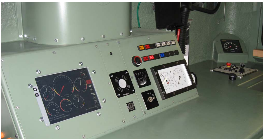
Übersichtlich angeordneter Führerstand einer Rangierlokomotive mit Kontrollinstrumenten und Bediengerät LocControl100 CP Richtung „1 Vorwärts“
